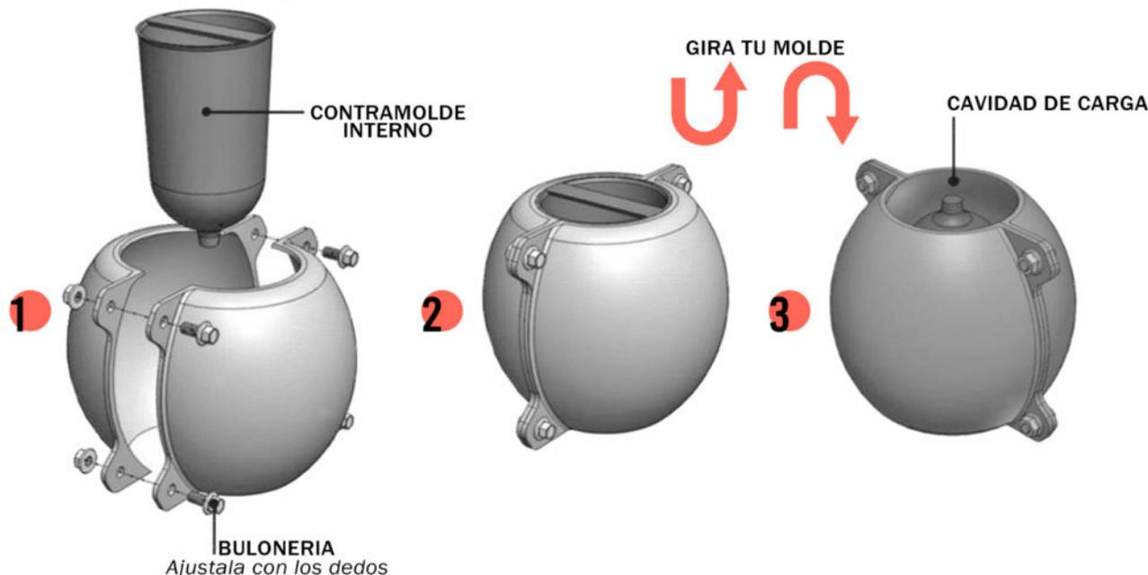
➤ 2→ Colocá el **DESMOLDANTE** por la cavidad de carga, puedes ayudarte con un pincel o esponja. Es fundamental que *CUBRAS* muy bien con desmoldante *TODA* la *SUPERFICIE* que va a entrar en contacto con la mezcla.
