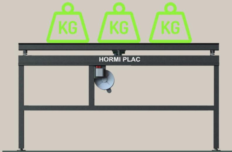
► 3º Afloja los tornillos de la corredera del motor.
