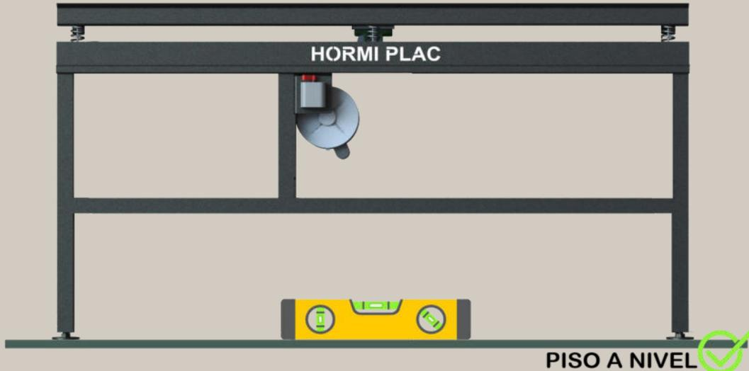
La mesa vibradora modelo CR-1 cuenta con un sistema de regulación manual en sus 4 puntos de apoyo. Los modelos CR-2, CR-3 y CR-4 no cuentan con esta regulación.
